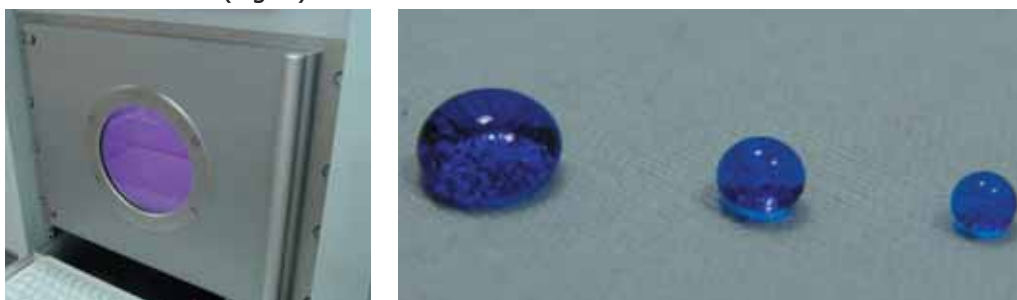
Fig. 1. Tejidos Hidrofóbico de algodón obtenido mediante la activación del plasma LP-O2 seguida de una polimerización de plasma de compuesto de fluorcarbono (Fuente: Centro Tecnológico Leitat)
